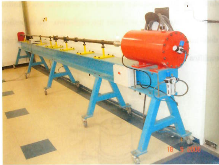
Figura 1.5: Barra de Hopkinson do Laboratório do GMSIE
