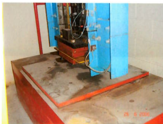
Figura 1.3: Peso e Área para colocação do corpo de prova do Laboratório do GMSIE
